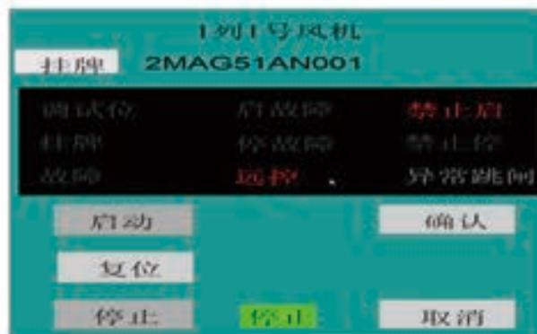
原空冷风机只能实现正转，并根据转速设定值在26.2至96转之间操作。
