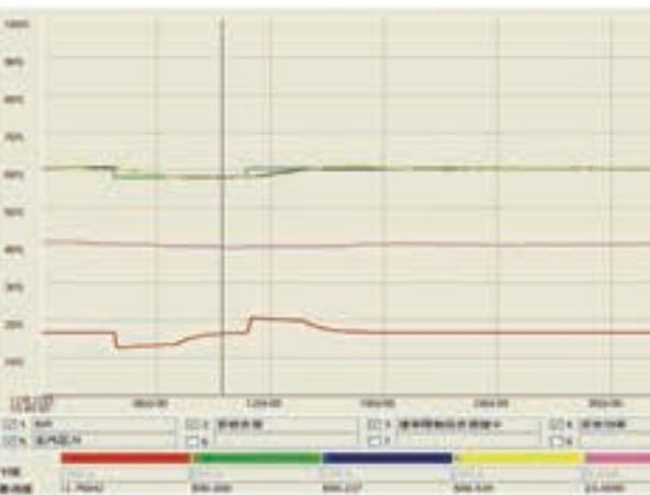
图三 双辽五号机在变工况时的BIR曲线
