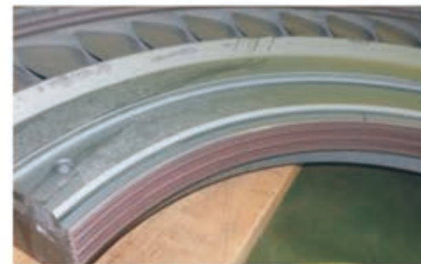
图1 梳齿型汽封块结构
