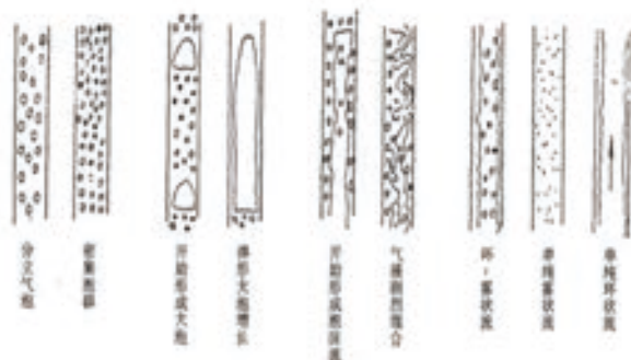
图2 垂直管道两相流流型
